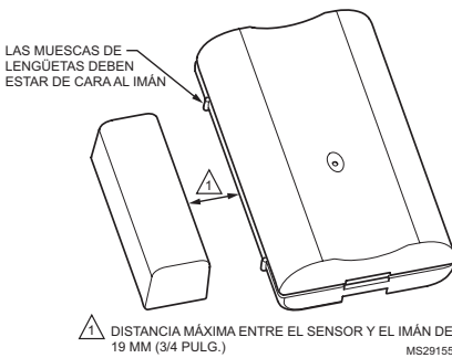
Fig. 8. Distancia máxima entre el sensor de puerta y el imán.
