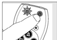
**4** Quando o seu televisor se desligar (ficando em modo de espera), solte imediatamente
