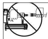
**AVERTISSEMENT** Toujours débrancher l'outil de la source de courant lorsqu'il est sans supervision, pour effectuer son entretien ou des réparations, pour débloquer, charger, décharger ou déplacer l'outil vers un nouvel endroit. Ne pas charger l'outil d'attachments lorsque la gâchette est enfoncée. L'outil pourrait décharger une attache menant à la mort ou à de graves blessures.
