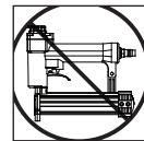
**DANGER** Ne toucher à la gâchette qu'au moment de poser des attaches. Ne jamais attacher de conduite d'air à l'outil ni transporter l'outil en touchant la gâchette. L'outil pourrait décharger une attache menant à la mort ou à de graves blessures. Actionner aussi le verrou de gâchette à une position sans danger lorsque l'appareil n'est pas utilisé.
