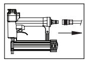
**AVERTISSEMENT** Toujours ajuster l'outil avec un raccord près de l'outil pour que tout air comprimé de l'outil soit déchargé lorsque le raccord est déconnecté. Ne pas utiliser de clapet de non-retour ou tout autre raccord qui laisse l'air rester dans l'outil. Ceci pourrait mener à des blessures graves ou à la mort.
