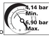
de 4,14 bar cuando la herramienta esté en uso. Si el suministro de aire es inadecuado podría haber pérdida de potencia y falta de consistencia en el funcionamiento.
