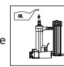
non-détrigante dans la prise d'air comprimé. Ne pas utiliser d'huile détergente, d'additif à huile ni d'huile pour outils à air comprimé. Ces dernières contiennent des solvants qui peuvent endommager les pièces intérieures de l'outil.
