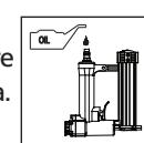
en la entrada de aire. No use aceites detergentes, aditivos de aceite, ni aceites para herramientas neumáticas. Los aceites para herramientas neumáticas contienen solventes que pueden averiar los componentes internos de la herramienta.
