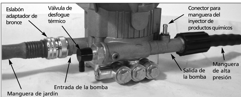
Figura 2 - Conexión de la bomba
