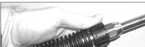
Figura 6 - Conecte la lanza a la pistola
