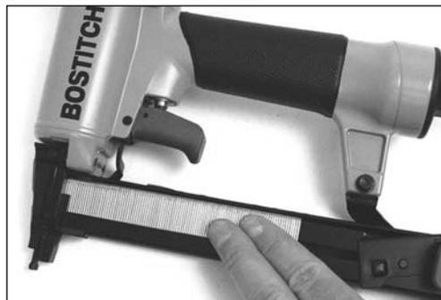
3. Tirer la poignée rouge vers l'arrière jusqu'à ce qu'elle s'engage. Le couvercle s'ouvre. L'avant du poussoir s'insère dans l'encoche sur le chargeur d'agrafes.
