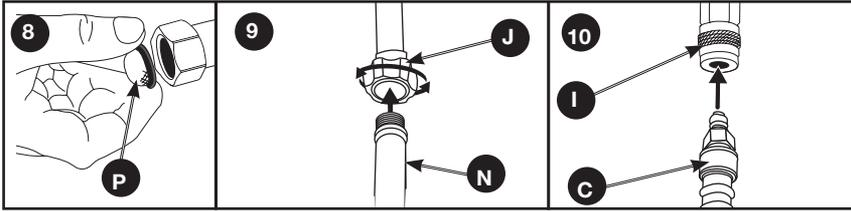
**⚠ AVERTENCIA:** Para reducir la posibilidad de contaminación proteja siempre el sistema contra la contracorriente cuando realice una conexión al sistema de agua potable.
