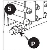
**Suministro de agua:** Todas las lavadoras a presión deben tener un suministro de agua. Los requerimientos mínimos para el suministro del agua son 19 L/min a 138 kPa (5 GPM a 20 psi). Si votre source d'eau est un puits, la longueur du boyau d'arrosage doit être limitée à 9 m (30 pi).
