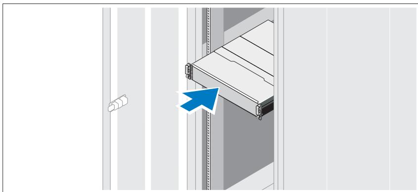
Zamontuj prowadnice i zainstaluj system w stojaku zgodnie z instrukcjami dotyczącymi bezpieczeństwa oraz instrukcjami dotyczącymi montowania systemów w stojaku dostarczonymi wraz z systemem.
