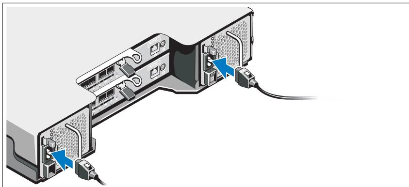
Asegúrese de que el interruptor de alimentación esté en la posición de APAGADO antes de conectar los cables de alimentación. Conecte los cables de alimentación al sistema.
