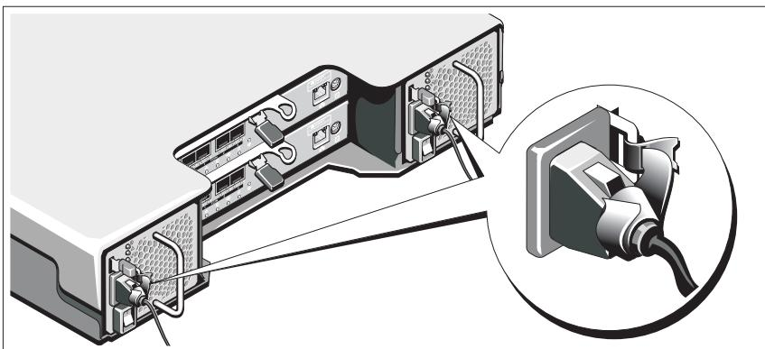
Fixez fermement les câbles au support de fixation à l'aide de la lanière fournie. Branchez ensuite l'autre extrémité des câbles d'alimentation sur une prise de courant mise à la masse ou sur une source d'alimentation autonome (onduleur [UPS] ou unité de distribution de l'alimentation [PDU]...). Chaque bloc d'alimentation doit être connecté à un circuit d'alimentation séparé.
