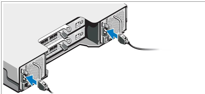
Upewnij się, że przycisk zasilania znajduje się w położeniu wyłączonego przed przystąpieniem do podłączania kabli zasilania. Podłącz kable zasilania do systemu.
