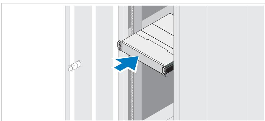
Смонтируйте направляющие кронштейны и установите систему в стойку согласно прилагаемым инструкциям по технике безопасности и инструкциям по установке стойки.
