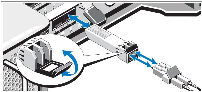
Aby odłączyć kabel światłowodowy:
