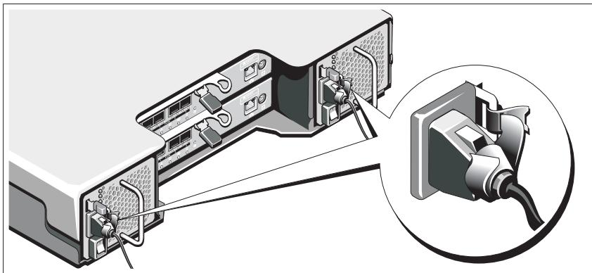
Befestigen Sie die Kabel fest mit der Halterung, und verwenden Sie dazu das mitgelieferte Band.
