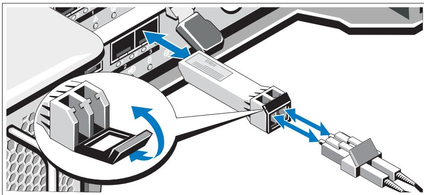
So entfernen Sie ein FC-Kabel:
