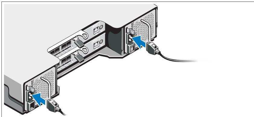
Stellen Sie sicher, dass der Netzschalter auf der OFF (AUS)-Einstellung ist, bevor Sie die Stromversorgungskabel verbinden. Verbinden Sie das bzw. die Stromversorgungskabel mit dem System.
