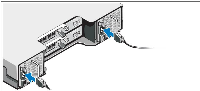
Avant de connecter les câbles d'alimentation, assurez-vous que le commutateur d'alimentation est en position OFF (ÉTEINT). Branchez le ou les câbles d'alimentation sur le système.
