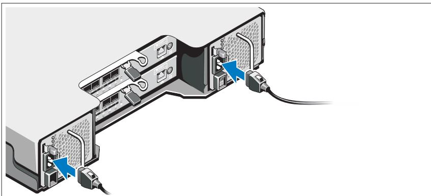
Předtím, než připojíte napájecí kabely, se prosím ujistěte, že se vypínač nachází v poloze VYPNUTÝ. Připojte napájecí kabely k systému.
