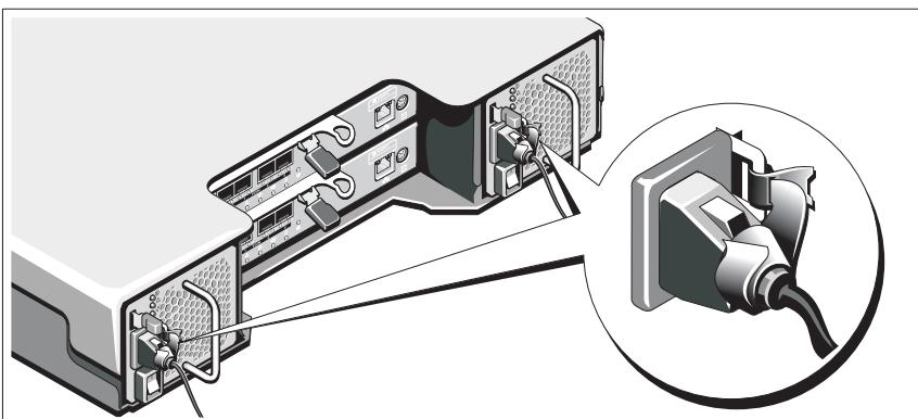
Pomocí řemínku pevně připevněte kabely k držáku.
