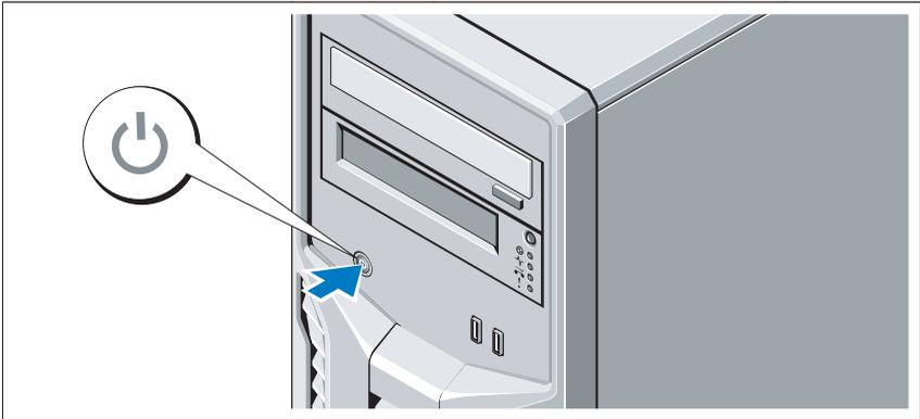
Drücken Sie den Netzschalter am System. Daraufhin sollte die Betriebsanzeige aufleuchten.
