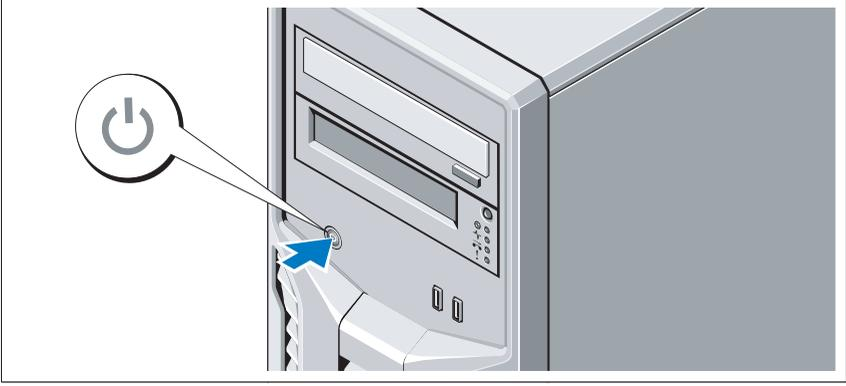
Sistem üzerindeki güç düğmesine basın. Güç göstergesi yanmalıdır.
