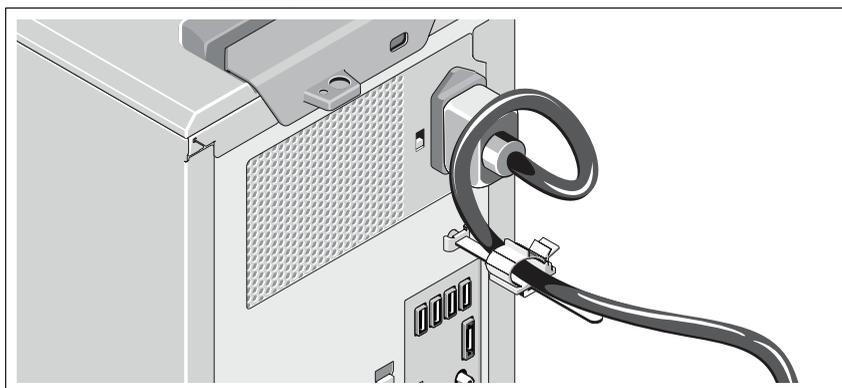
Zegnij kabel zasilacza, tworząc pętlę, w sposób przedstawiony na rysunku i przymocuj do zacisku kabla.
