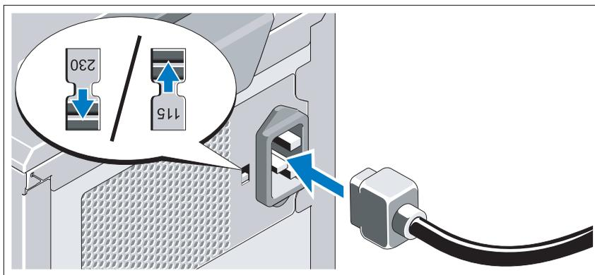
**△ PRZESTROGA:** Należy upewnić się, że na przełączniku wyboru napięcia zasilacza wybrano wartość napięcia najbardziej zbliżoną do napięcia prądu zmiennego w miejscu instalacji systemu.
