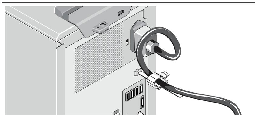
Faites une boucle comme indiqué dans l'illustration et insérez le câble d'alimentation du système dans le clip.
