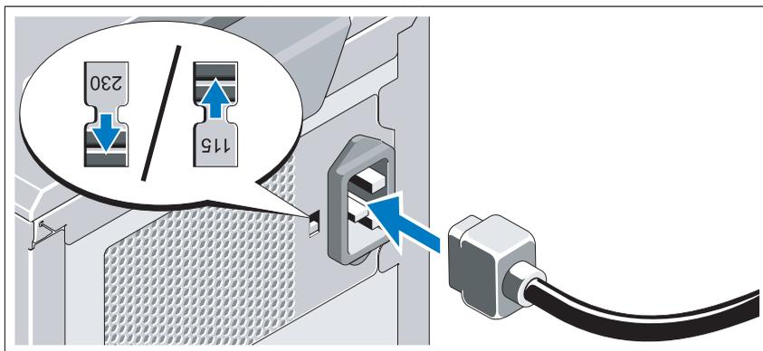
**△ UPOZORNĚNÍ:** Nezapomeňte nastavit přepínač napětí na zdroji napájení na hodnotu, která nejlépe odpovídá napájení střídavým proudem dostupnému ve vašem místě.
