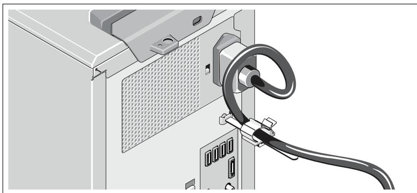
Udělejte na napájecím kabelu smyčku, jak je znázorněno na obrázku, a připevněte ho do příslušného úchyty.
