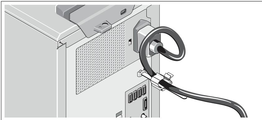
Doble el cable de alimentación del sistema en forma de bucle, como se muestra en la ilustración, y fíjelo a la abrazadera.
