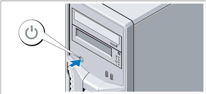
Presione el botón de encendido del sistema. El indicador de alimentación debería encenderse.
