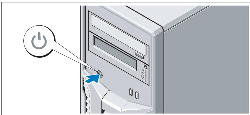
Stiskněte tlačítko napájení na systému. Měl by se rozsvítit indikátor napájení.
