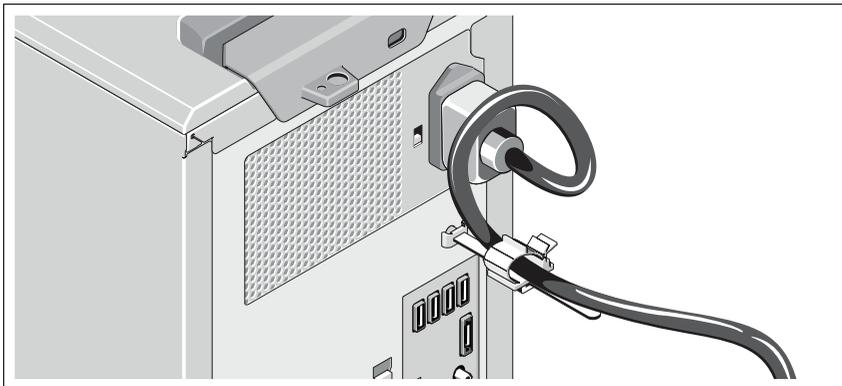
Bilden Sie mit dem Netzstromkabel wie abgebildet eine Schlaufe und befestigen Sie es an der Kabelklemme.
