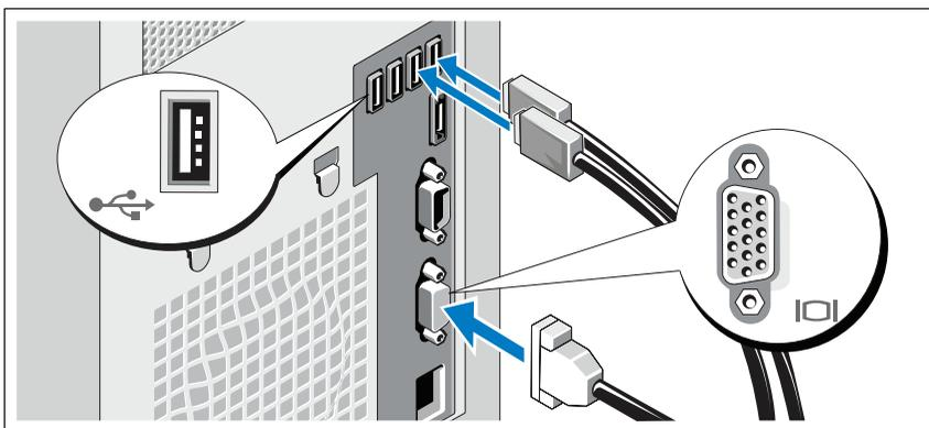
Подключите клавиатуру, мышь и монитор (дополнительно).
