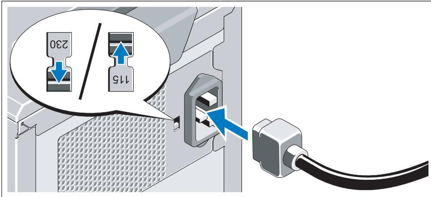
**⚠ VORSICHTSHINWEIS:** Der Spannungswahlschalter am Netzteil muss auf den Spannungswert eingestellt sein, der der örtlichen Netzspannung am nächsten kommt.
