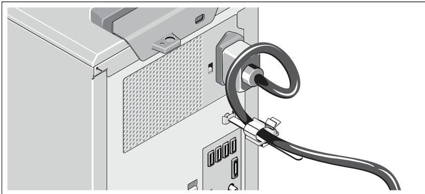
Κάμψτε το καλώδιο τροφοδοσίας του συστήματος σε μορφή βρόχου, όπως φαίνεται στο σχήμα, και συνδέστε το στην αγκράφα του καλωδίου.
